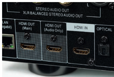
Jedno z wyjść HDMI przesyła komplet sygnałów; drugie pełni rolę wyjścia audio, ewentualnie pomoże w komunikacji ze starszymi amplitunerami (HDMI v1.4).
