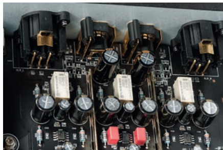
Niezależna sekcja dwukanałowa otrzymuje wprost z przetwornika DAC sygnał symetryczny; bufor wyjściowe zrealizowano na bardzo dobrych wzmacniaczach operacyjnych Burr Brown.
