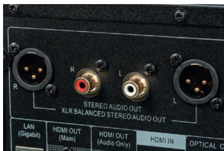
Dla sygnału stereo przygotowano dwa niezależne wyjścia – RCA oraz XLR.
