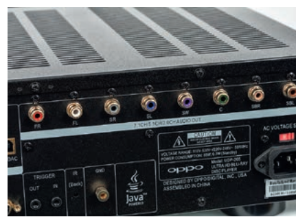
Wyjście analogowe 7.1 otwiera specjalne możliwości – dzięki regulacji poziomom, UDP-205 można podłączyć do końcówki mocy.
