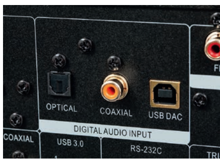
Aby wykrzesać maksimum z sekcji audio, UDP-205 należy przestawić w tryb USB-DAC – wówczas odtwarzacz przyjmuje nawet materiały PCM 32/768 oraz DSD512.
